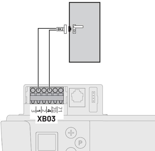
Une fois l'accessoire raccordé et son intégration au réseau, la commande le détecte automatiquement.
