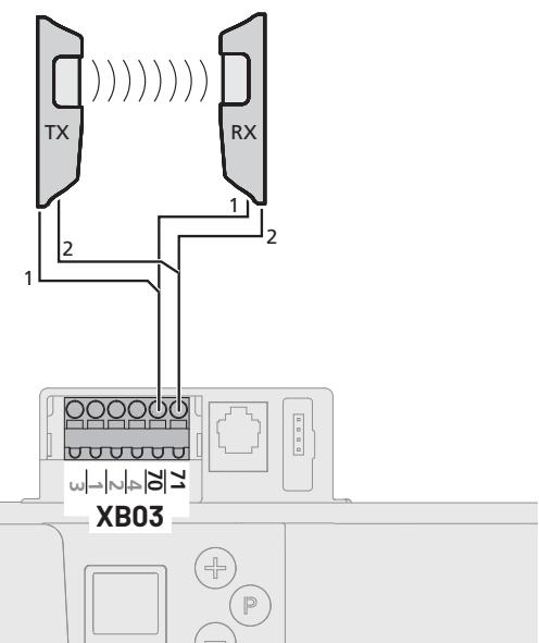
La commande détecte automatiquement une barrière lumineuse raccordée dès lors que l'alimentation électrique est raccordée. La barrière lumineuse peut être reprogrammée ultérieurement. Les barrières lumineuses non souhaitées doivent être déconnectées avant de raccorder l'alimentation électrique, car sinon la commande les détectera.
