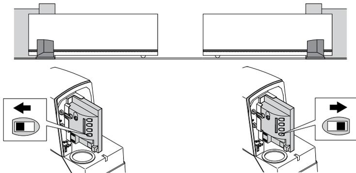
On peut choisir l'un ou l'autre moteur comme Master et comme Esclave ; dans le choix, il faut tenir compte de la commodité des connexions et du fait que la commande Pas à pas sur le Slave permet l'ouverture totale uniquement de la partie commandée par le moteur Slave
