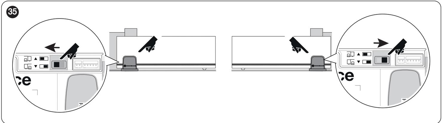
Pour installer 2 **ROBUS** en mode Master et Slave, effectuer les opérations suivantes :
