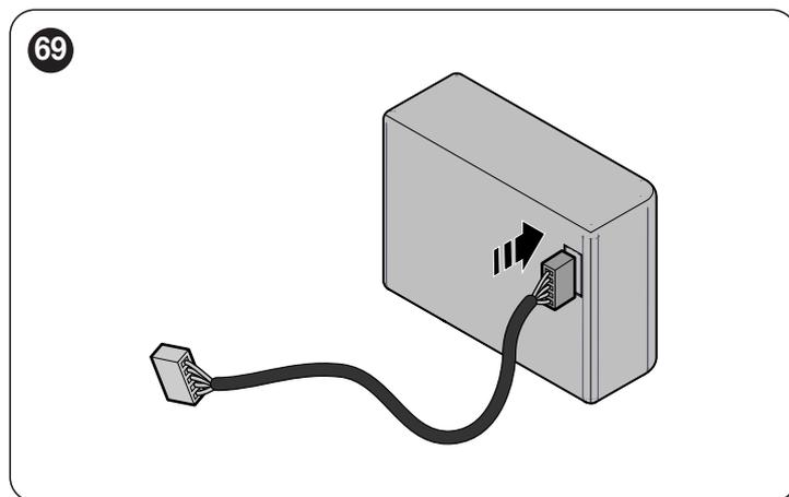
3. insérer le connecteur (C) correspondant sur le connecteur sortant du logement moteur (« **Figure 70** »)
