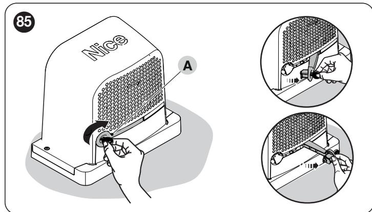
2. À ce stade, il est possible de déplacer manuellement l'automatisme dans la position souhaitée.
