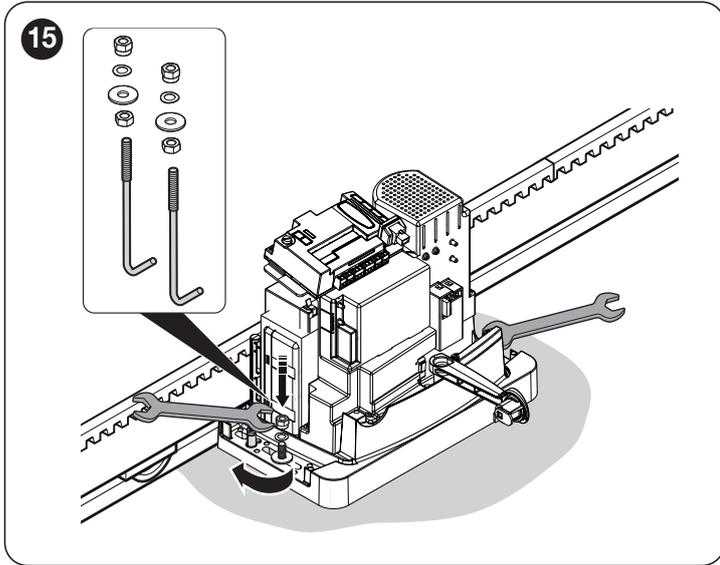
9. régler la hauteur de l'opérateur à l'aide des goujons de réglage (H) et positionner le pignon à environ 1 ou 2 mm par rapport à la crémaillère afin d'éviter que le poids du vantail ne pèse sur l'opérateur («Figure 16»)
