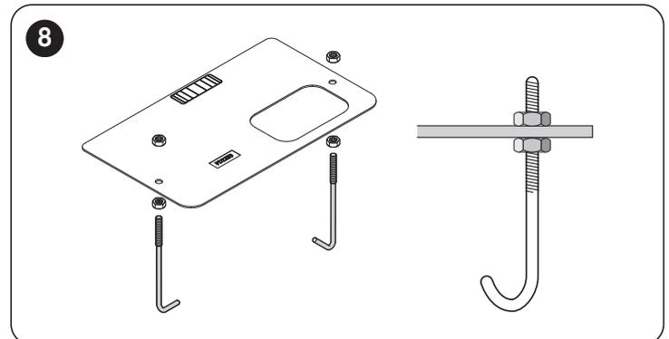
3. couler le béton pour fixer la plaque de fondation («Figure 9»)
