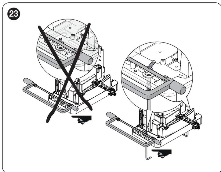
16. bloquer le câble dans le serre-câble afin d'éviter de l'endommager lors des étapes suivantes («Figure 24»)
