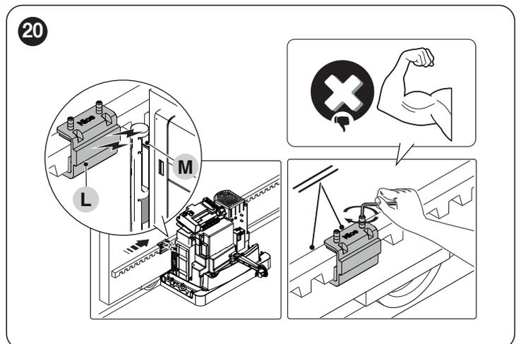
**!** La patte de fin de course avec son aimant ne doit pas être aligné avec le capteur. En cas d'alignement, la portée de ce dernier serait faible et le portail risquerait de ne pas s'arrêter correctement.
