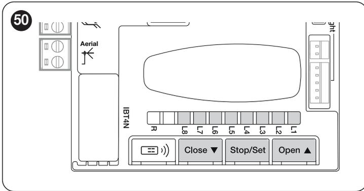
Les fonctions programmables disponibles sont installées sur **deux niveaux** et leur état de fonctionnement est signalé par huit led « **L1 ... L8** » présentes sur la centrale (led allumée = fonction active ; led éteinte = fonction non active).
