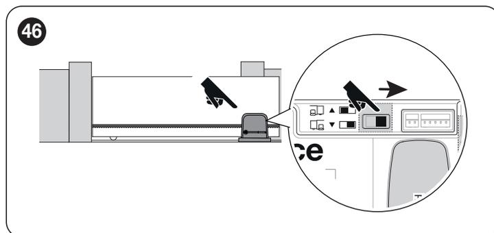
Avec le sélecteur positionné comme sur la **figure 47**, l'ouverture de l'automatisme est effectuée en déplaçant l'automatisme dans la direction opposée au moteur.
