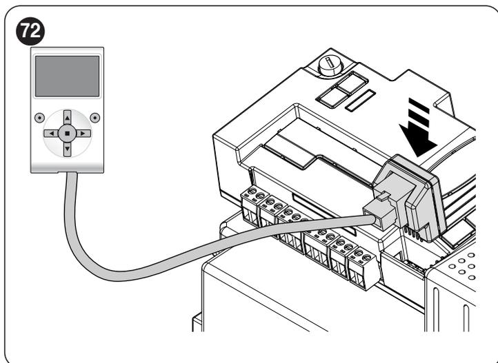
L'Oview peut être relié simultanément à plusieurs centrales (jusqu'à 16 sans précautions spéciales) et peut même rester branché à la centrale pendant le fonctionnement normal de l'automatisme. Dans ce cas, il peut être utilisé pour envoyer directement les commandes à la centrale en utilisant le menu « utilisateur ».
