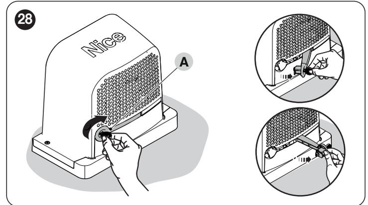
2. À ce stade, il est possible de déplacer manuellement l'automatisme dans la position souhaitée.
