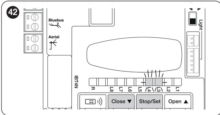
Cette procédure permet de programmer rapidement les cotes d'ouverture et de fermeture, en permettant à la logique de commande de calculer automatiquement les cotes intermédiaires qui peuvent être modifiées par la suite à l'aide de l'app « myNice Pro » et des interfaces compatibles.
