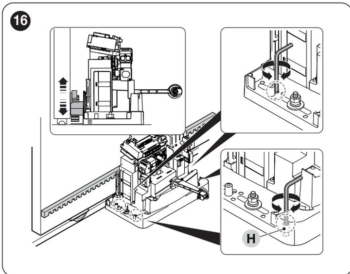
10. ouvrir et fermer manuellement le vantail du portail et vérifier qu'il coulisse sans frictions. Contrôler également que la crémaillère est toujours alignée avec le pignon («Figure 17»)
