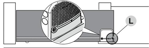
Une fois le moteur déverrouillé, placer le portail en position d'ouverture. Dans ce cas, la led d'état (L) verte doit s'allumer. Fermer le portail et verrouiller à nouveau le moteur.
