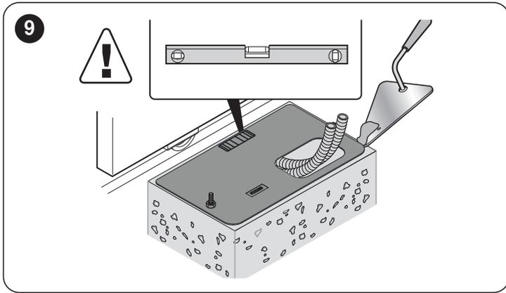
⚠ **Contrôler, avant le durcissement du béton, que la plaque de fondation est parfaitement nivelée et parallèle au vantail du portail.**
