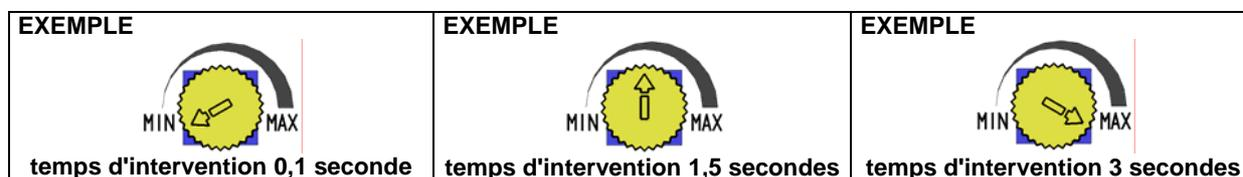
**Si le trimmer OBS est en position MAX, on exclut la détection d'obstacle.**
