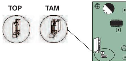
(\*\*) Pour les émetteurs de fréquence 433.92 AM (série TOP et série TAM) il faut positionner le pontet sur la carte AF43S correspondante de la façon indiquée.
