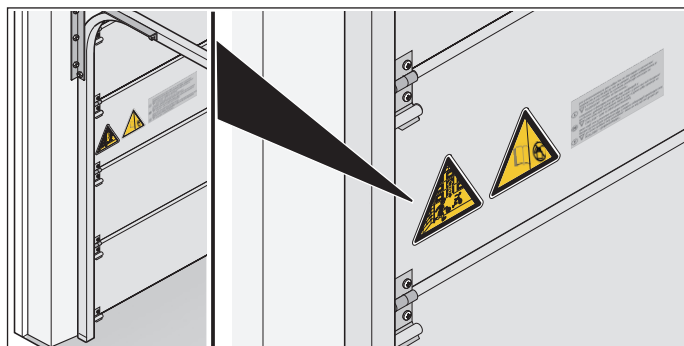
III. 1.2 Pose des autocollants sur le tablier
