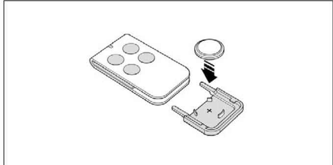
**04.** En tenant l'émetteur avec les touches vers le haut, remettre le couvercle en place en faisant en sorte que la « lamelle » représentée en gris se trouve au-dessus la pile, comme l'illustre la figure ci-après.
