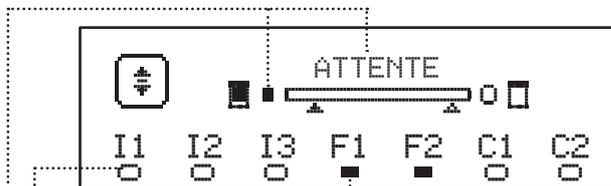
Le tableau de commande (en veille) indique l'état physique des contacts au bornier et des touches de programmation :
