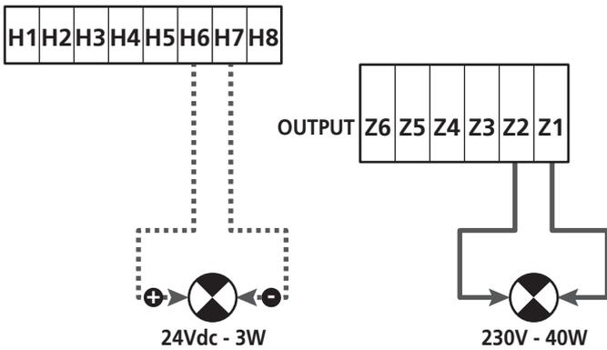
Le fonctionnement normal du clignotant prévoit l'activation pendant les phases d'ouverture et de fermeture de la porte.
