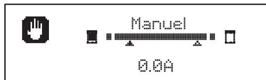
Le mode de mouvement manuel reste actif pendant 1 minute, puis l'armoire revient au fonctionnement normal. Pour revenir immédiatement au fonctionnement normal, appuyer sur la touche **OK** pendant 1 seconde.
