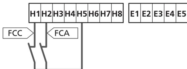
La position des fins de course est mémorisée pendant la procédure d'apprentissage de la course et pendant le fonctionnement normal de la porte, l'armoire s'attend à détecter les fins de course dans des positions déterminées.
