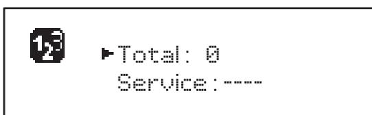
3. Pour activer la demande de maintenance, sélectionner la fonction **Service** et appuyer sur **OK**.
