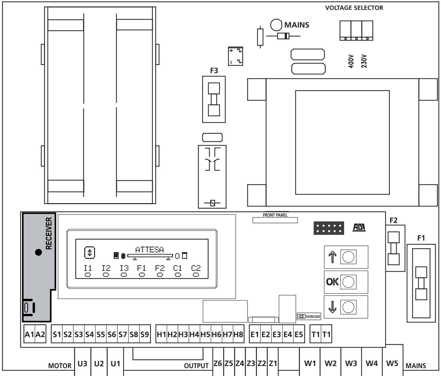
\* **H3 - H4** : l'encodeur utilise les mêmes bornes que les switches pour les positions intermédiaires. Si un encodeur est utilisé, il n'est pas possible d'utiliser les switches pour les positions intermédiaires et vice-versa.
