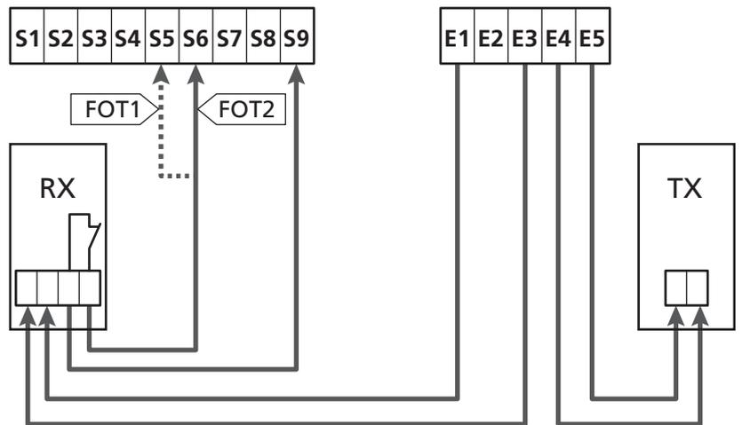
Paramètre FOT1 ⇔ DEFAULT = NO (aucune fonction)
