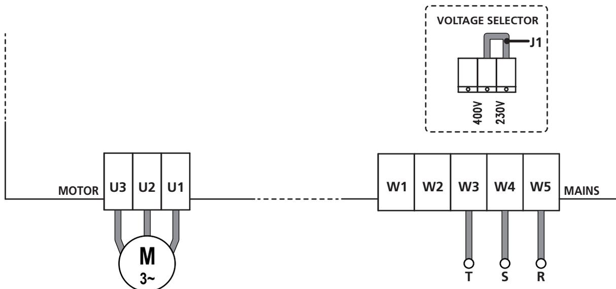
**ATTENTION :** avant de mettre sous tension s'assurer que la liaison de sélection de la tension (J1) soit réglée correctement. Une configuration non correcte peut sérieusement endommager l'armoire de commande
