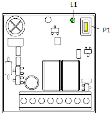
1. Sur la carte électronique du récepteur, appuyez sur le bouton de programmation P1 une fois pour enregistrer le bouton sur le canal 1. Relâchez-le. La diode L1 s'allume.
