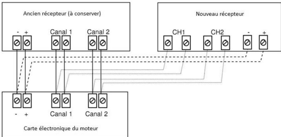
1. Branchez avec les fils électriques le canal 1 entre les bornes CH1 (il faut insérer le fil dans le trou sous les vis puis visser les vis pour le bloquer). Les bornes peuvent aussi être indiquées par le symbole de l'interrupteur :
