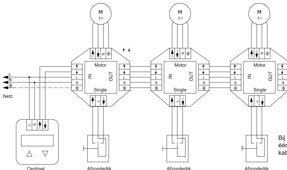
Bij aansluiting van meer dan 4 motoren op één toevoerkabel moet een grotere kabeldiameter worden gebruikt.
