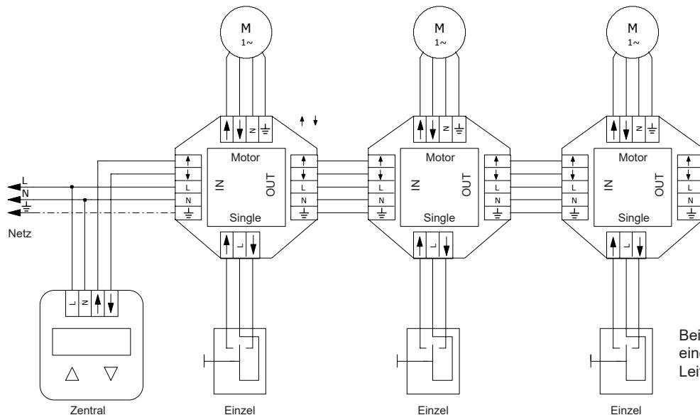
Bei Anschluß von mehr als 4 Motoren an eine Zuleitung sollte ein größerer Leitungsquerschnitt verwendet werden.
