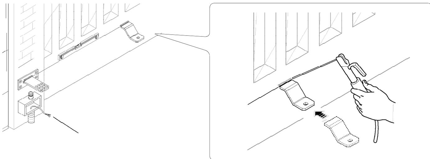
📖 Sur des vantails non métalliques, assembler et souder les deux parties de l'étrier et les fixer à l'aide de vis spécifiques.
