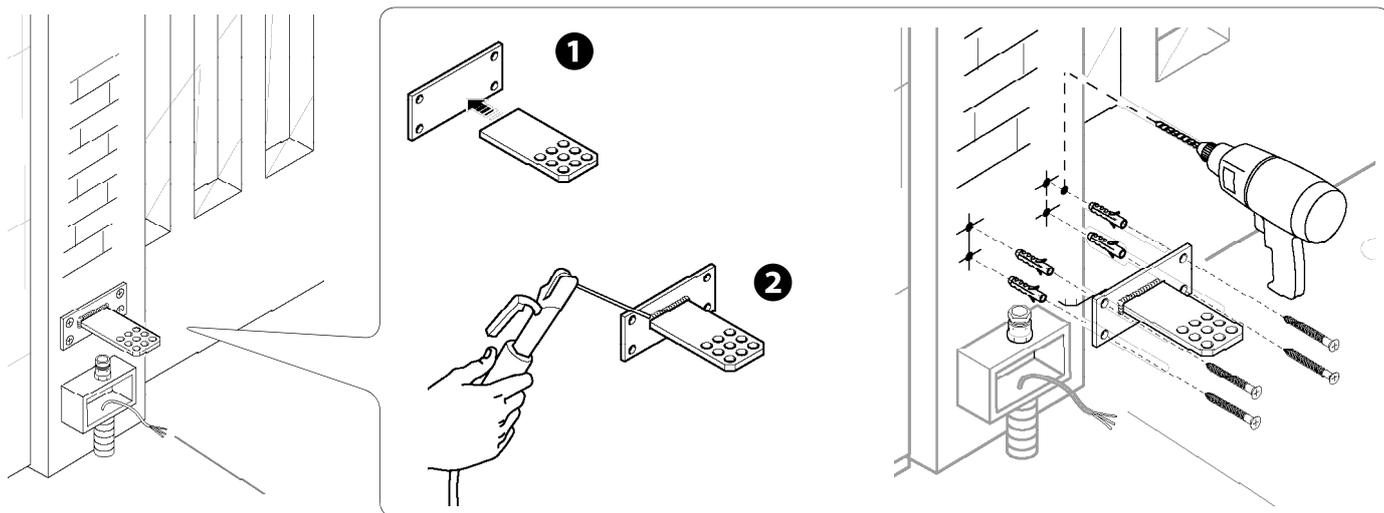
Souder l'étrier portail sur le vantail en respectant les dimensions indiquées dans le tableau.
