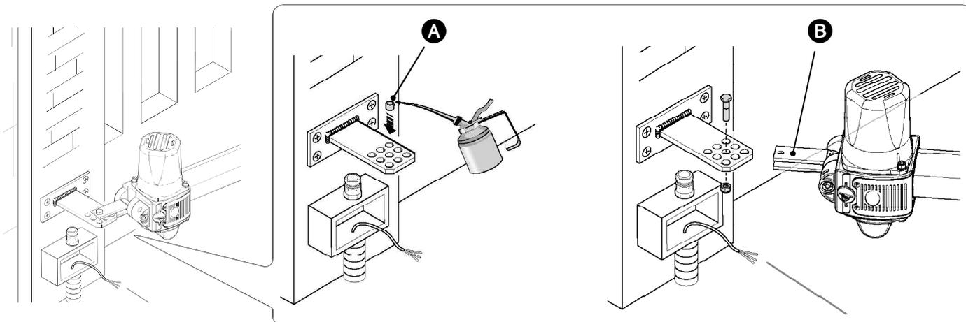
Ouvrir le vantail, introduire le goujon dans le trou de l'étrier portail et le fixer avec la rondelle et l'écrou fournis.
