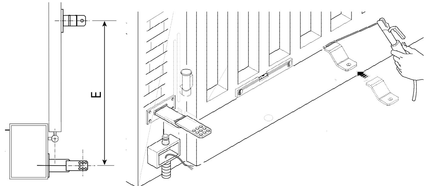
Fixer le motoréducteur aux étriers au moyen des vis et des écrous fournis.
