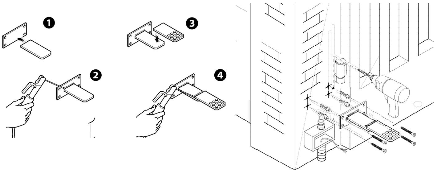
Ouvrir le portail à 90°, souder ou fixer l'étrier portail à l'aide de vis appropriées (en respectant la dimension E indiquée dans le tableau).
