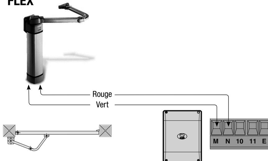
Pour le montage à droite, inversez les câbles de raccordement : (M-Rouge, N-Vert)
