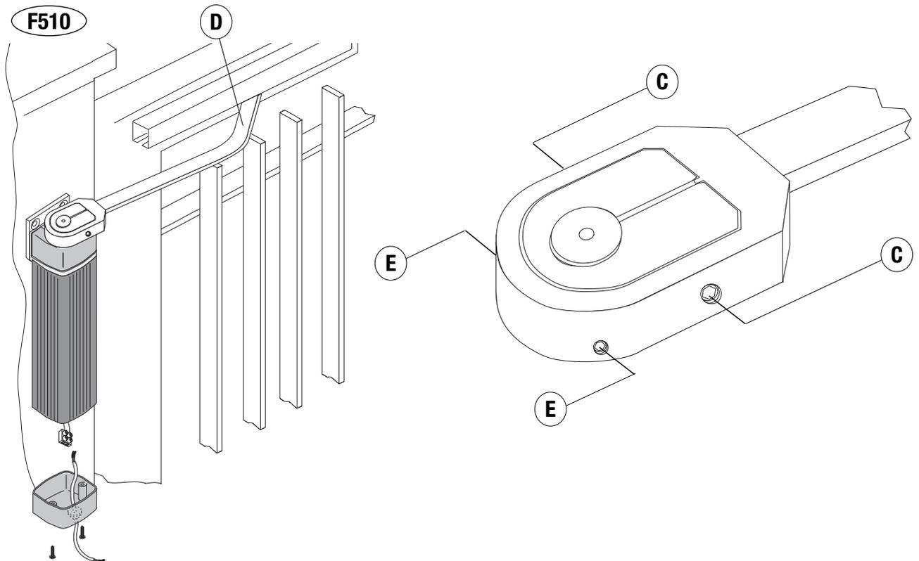
6) Terminer l'installation en fixant le couvercle supérieur avec le joint torique correspondant.
