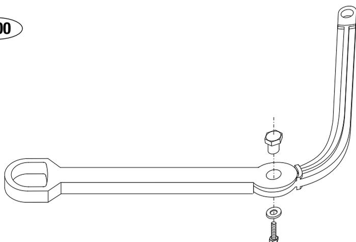
2b) Fixer le rail de guidage au vantail et monter le bras droit.
