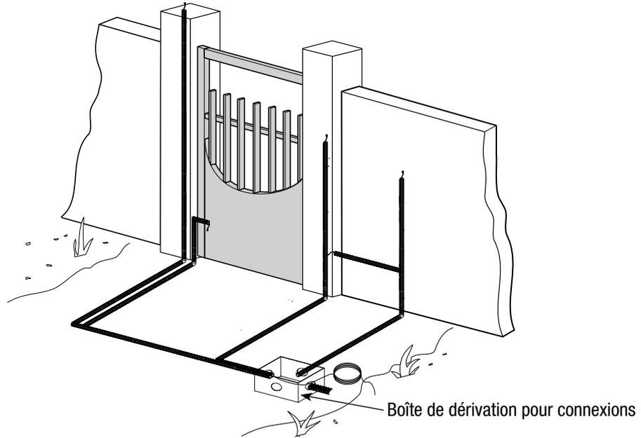
1) Tracer les axes et les encombres de l'ensemble en se référant aux schémas de page 2 et 3, puis fixer la bride du motoréducteur au mur ou au pilier. Pour le motoréducteur F500, fixer le support de fixation au portail.
