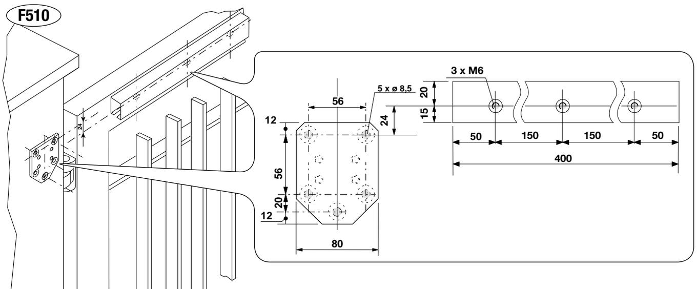
2a) Assembler le bras articulé en reliant les deux demibras avec la boulonnerie prévue à cet effet.
