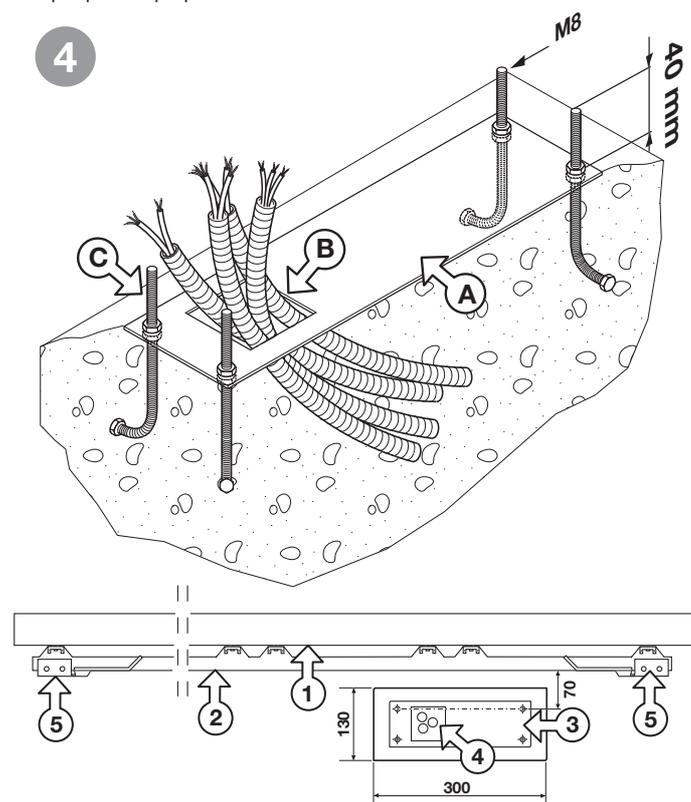
Si le rail de guidage existe déjà, le plot en ciment devra faire partie partiellement de la fondation du rail afin d'éviter que les deux structures ne cèdent l'une par rapport à l'autre.
