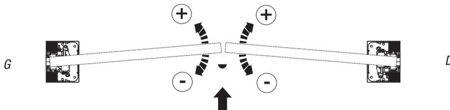
Opération de réglage en ouverture : même processus que pour le réglage en fermeture.
