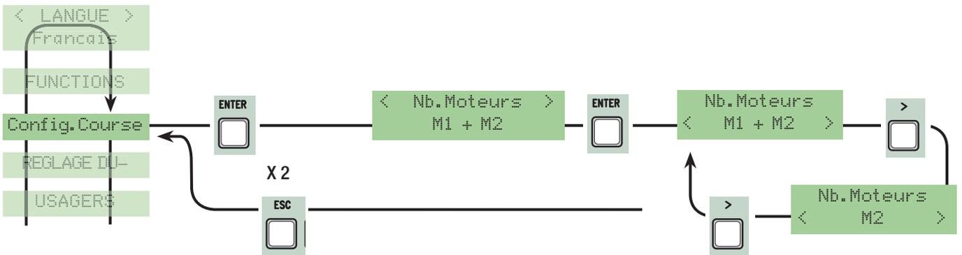
Type moteur : configuration du type de motoréducteur battant présent sur l'installation.
