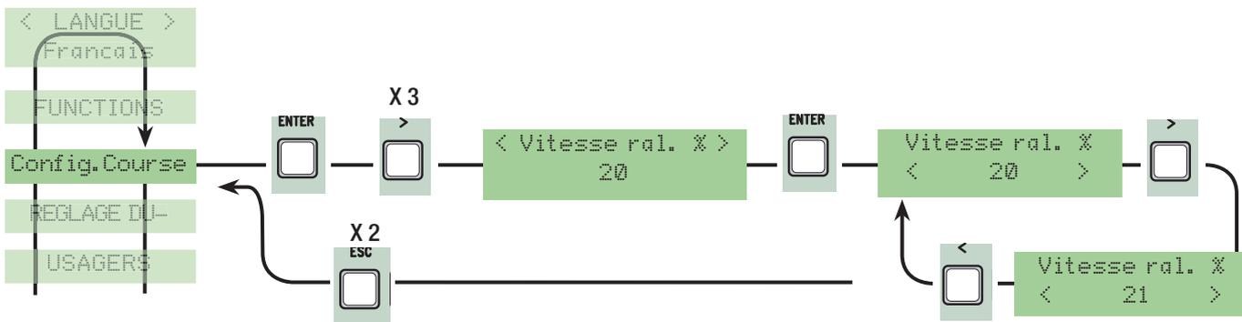
**Départ ralenti : après une commande d'ouverture ou de fermeture, les vantaux partent à une vitesse ralentie pendant quelques secondes.**
