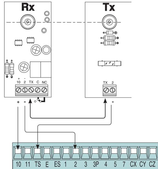
A chaque commande d'ouverture ou de fermeture, la carte contrôle le fonctionnement des photocellules. Une anomalie éventuelle détectée sur les photocellules est signalée par le clignotement de la Led sur la carte électronique et elle annule toute commande de l'émetteur radio ou du bouton.
