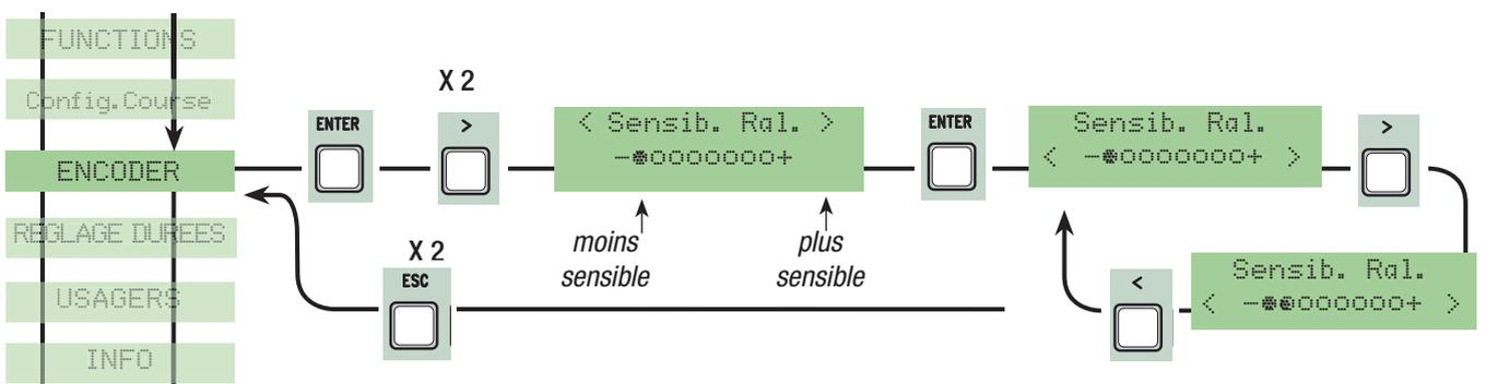
**Ralentissement Encodeur:** il active les points de départ du ralentissement en ouverture et en fermeture.
