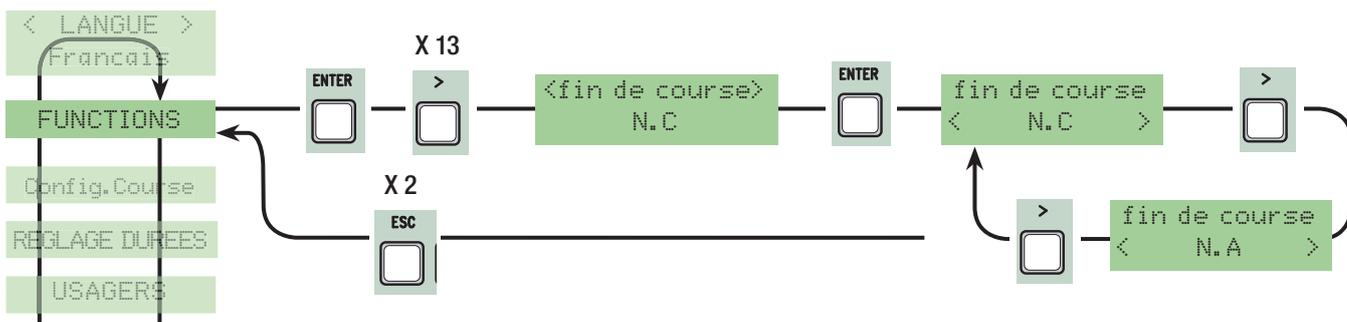
**Commande 2-7:** configuration du contact sur 2-7 en passe-passe (ouvre-ferme) ou séquentiel (ouvre-stop-ferme-stop).
