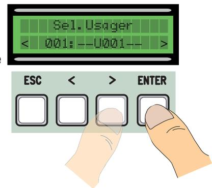
3) Utilisez la touche ENTER pour déplacer le curseur en avant, ESC pour déplacer le curseur en arrière et < et > pour sélectionner la lettre ou le chiffre.
