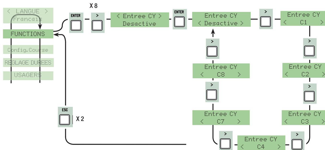
**Entrée CZ:** entrée contact de sécurité N.C. avec possibilité d'associer les fonctions suivantes : C1 (réouverture en phase de fermeture), C2 (ré-enclenchement de la fermeture en phase d'ouverture) C3 (stop partiel), C4 (attente obstacle), C7 (ré-ouverture en phase de fermeture, pour bords sensibles), C8 (ré-enclenchement de la fermeture en phase d'ouverture, pour bords sensibles) ou de le mettre hors service, voir dispositifs de sécurité sur connexions électriques.
