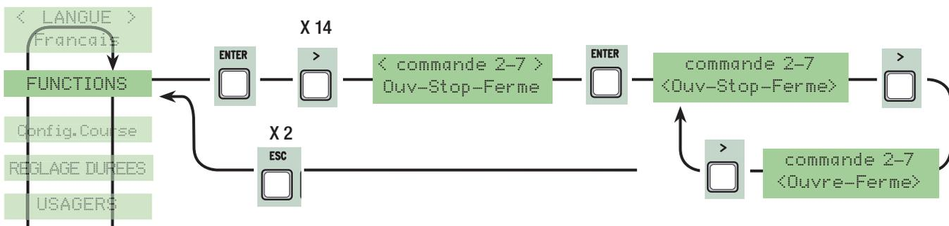
**Commande 2-3P:** configuration du contact sur 2-3P en ouverture piétons (ouverture totale du deuxième vantail) ou partielle (ouverture partielle du deuxième vantail selon la durée de temps configurée sur "Ouverture partielle" dans le menu "Réglage Durée de temps").
