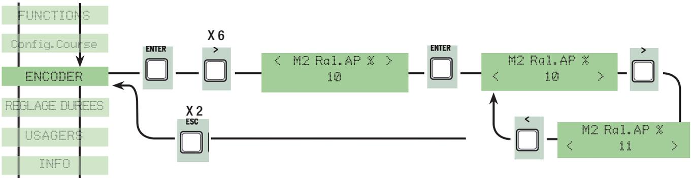
**M2 ralentissement fermeture en %:** il règle le point de départ du ralentissement du deuxième moteur (M2) avant le fin de course de fermeture.
