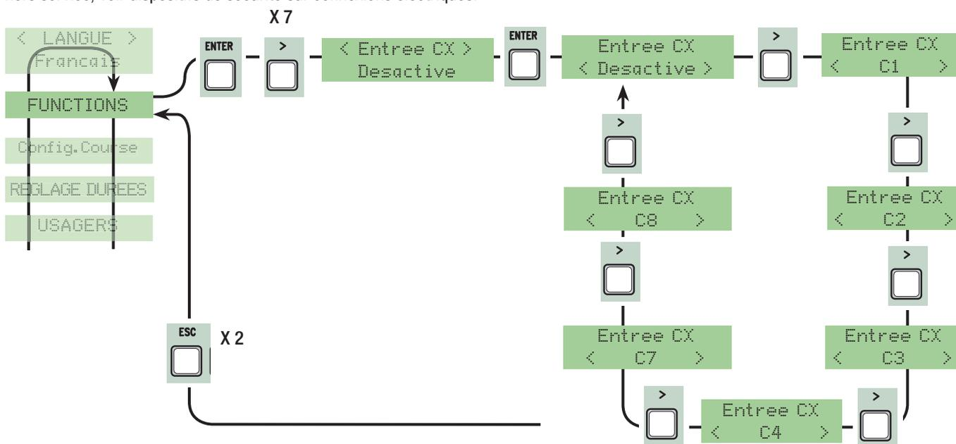
**Entrée CY:** entrée contact de sécurité N.C. avec possibilité d'associer les fonctions suivantes : C1 (réouverture en phase de fermeture), C2 (ré-enclenchement de la fermeture en phase d'ouverture) C3 (stop partiel), C4 (attente obstacle), C7 (ré-ouverture en phase de fermeture, pour bords sensibles), C8 (ré-enclenchement de la fermeture en phase d'ouverture, pour bords sensibles) ou de le mettre hors service, voir dispositifs de sécurité sur connexions électriques.
