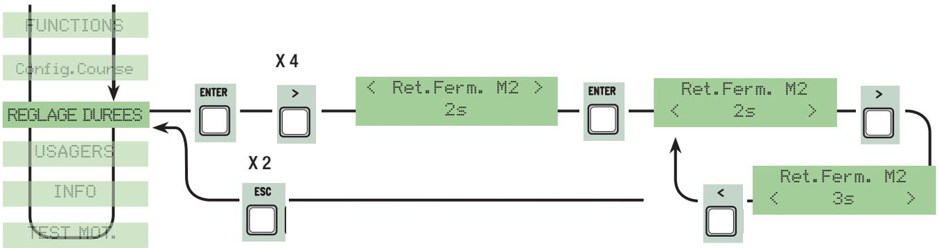
**Durée du préclignotement:** après une commande d'ouverture ou de fermeture, le clignotant connecté sur (W-E), clignote de 1" à 60" avant de commencer la manœuvre.
