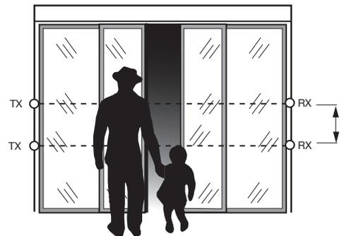
**3** **Installazione fotocellule - Fitting the photocell - Installation des cellules photoélectriques - Installation der Lichtschranke - Instalación fotocélulas**
