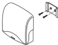
La fijación en la pared de la unidad en caja se efectúa con la ayuda de una abrazadera de "fijación rápida". Una vez efectuado las conexiones eléctricas, el contenedor se inserta a presión en la abrazadera. Si es necesario efectuar operaciones de mantenimiento después de la colocación es suficiente hacer una presión en la caja, empujando desde abajo hacia arriba para que el contenedor se desenganche.
