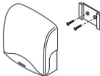
La fixation au mur de l'unité sous boîtier s'effectue au moyen de l'étrier "fixation rapide". Après avoir effectué les branchements électriques, embrocher le boîtier sur l'étrier. Pour effectuer ensuite l'entretien, il suffira de le débrocher en exerçant une pression du bas vers le haut.
