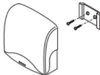
Die Wandbefestigung der Einheit mit Gehäuse erfolgt mittels eines "Schnellbefestigungsbügels". Nach Vornahme der elektrischen Anschlüsse wird das Gehäuse durch Einrasten auf dem Haltebügel angebracht. Im Falle von Wartungsarbeiten nach der Installation genügt ein auf das Gehäuse ausgeübter Druck von unten nach oben, um das Gehäuse auszuhaken.
