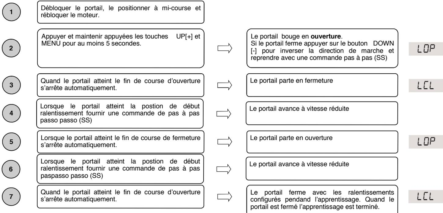
**Attention:** en cas d'intervention d'un dispositif de sécurité, la procédure sera arrêtée et l'écran affichera le message Appuyer sur la touche pas à pas pour redémarrer l'apprentissage à partir de l'étape 2.
