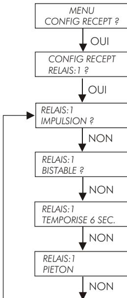
Une fois sélectionnée le fonctionnement du relais 1 (ou du relais 2) avec la touche GAUCHE de l'émetteur MAITRE et donnée la confirmation avec la touche DROITE, l'afficheur LCD donne le message MISE A JOUR OK et il revient au menu principal.
