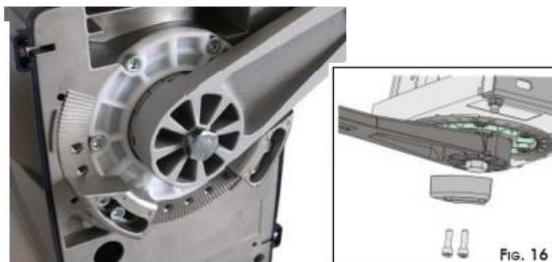
Il est préconisé d'installer les butées internes en ouverture et en fermeture
