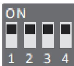
1- Positionner les DIP 1,2, 3 et 4 sur ON-ON-ON-ON.-
