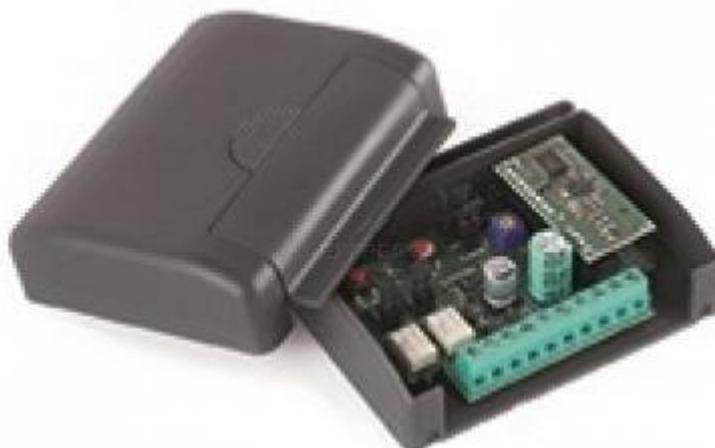
Le récepteur est doté de deux relais dont les sorties sont marquées respectivement par CH1 (contact N.O. – N.F.) et CH2 (contact N.O. - N.F.). Pour associer les fonctions CHA, CHB, CHC et CHD des unités transceiver mobiles aux relais CH1 et CH2, agir sur les cavaliers J1 situés sur le circuit (Voir la figure ci-dessous) - CHA = CH1 et CHB = CH2).
