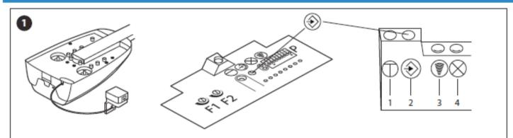
Repérer la touche sur le moteur CRAWFORD (soit à l'arrière du moteur soit en démontant le capot du moteur). Enfoncer brièvement la touche, sur puis relâcher. Le voyant s'allume.
